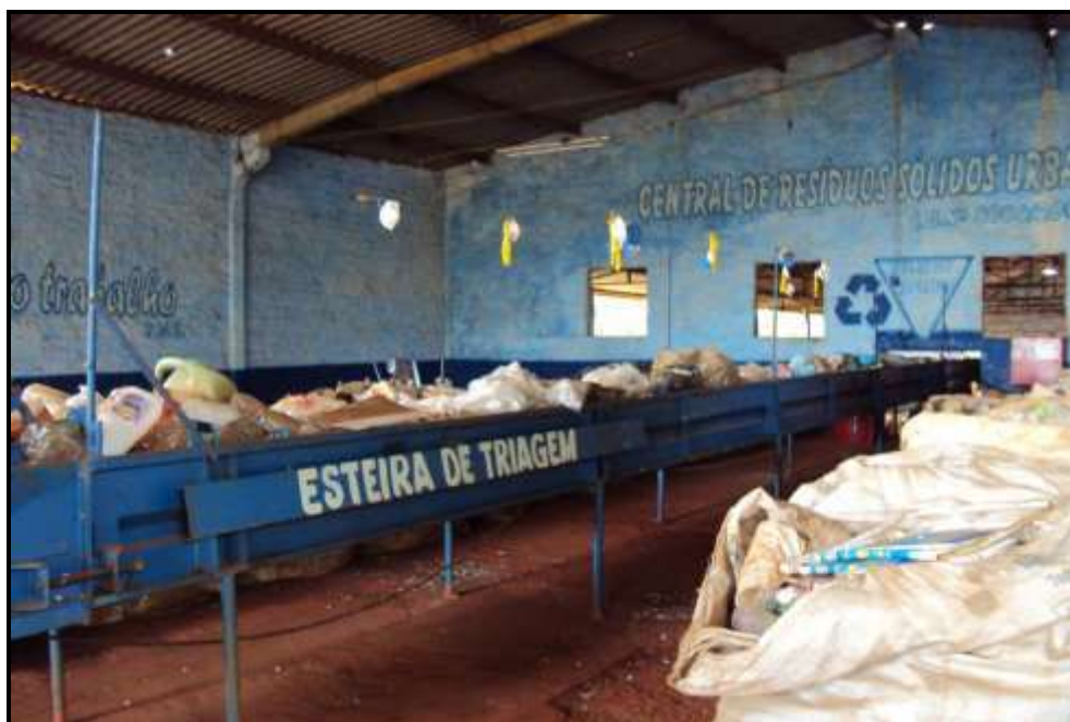
Figura 12 : Esteira de triagem de materiais Fonte: SIMPEX Ltda.
